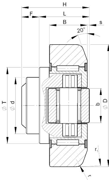
Die Axialrolle wird durch Demontage des Frontdeckels freigelegt. Durch Drehen der Achse kann das Maß H, L und s, je nach Rollengröße, zwischen 1,5 mm und 4,0 mm verändert werden.
