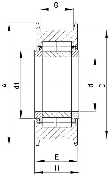
Kettenumlenkrollen werden unter anderem bei Maschinen und Gabelstaplern als Umlenkrolle eingesetzt. Über die am Hubzylinder oder Innenmast befestigte Kettenrolle werden die Zugketten umgelenkt. Abhängig von der Hubgerüstkonstruktion kann der Umschlingungswinkel bis zu 180° betragen. Die Beanspruchung der Rollen richtet sich nach der Anzahl der Ketten, dem Umschlingungswinkel, sowie der Tragfähigkeit der Maschine.
